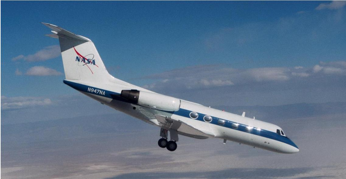
*Figura 2: "Shuttle Training Aircraft", vehículo de entrenamiento de la NASA que simulaba el comportamiento dinámico del "Space Shuttle" (2003)*
